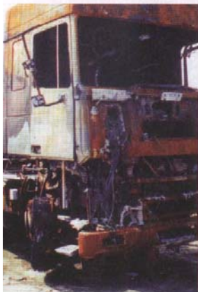
Ausgebrannte Zugmaschine. Der Sattelaufleger hatte Kontakt mit der Freileitung. Nach kurzer Zeit gerieten die Bereifung und danach das ganze Fahrzeug in Brand
