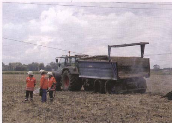
Beim Absenken der Mulde wurde die Freileitung heruntergezogen. Als der Fahrer vom Schlepper abstieg, kam es zur tödlichen Körperdurchströmung. Nach einiger Zeit geriet die Bereifung des Muldenkippers in Brand
